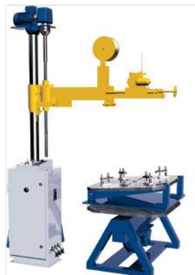
3. Электродуговая наплавка уплотнительных поверхностей деталей затвора арматуры
