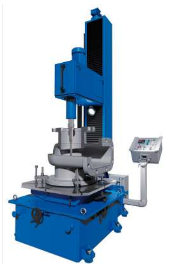
5. Шлифование и притирка уплотнительных поверхностей деталей затвора арматуры
