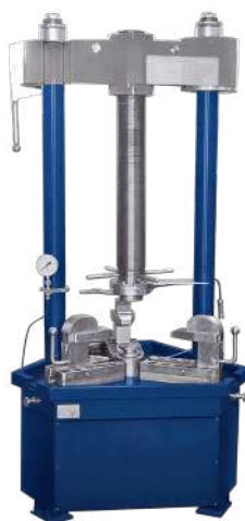
6. Испытание арматуры на прочность и герметичность
